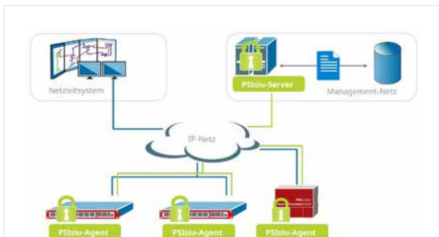
Рис. 1: Настройка параметров и обновление с помощью системы управления исправлениями и обновлениями PSIngo/PD.
